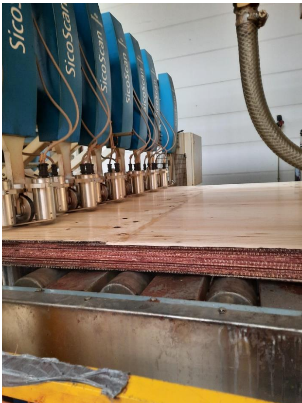
Und so sieht ein Furnierschichtholz aus, wenn es frisch aus der Presse kommt.
